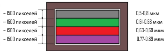
Расположение спектральных фильтров на ФПУ для варианта 1
