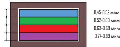
Расположение спектральных фильтров на ФПУ для варианта 2
